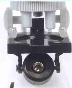
C Die Lampe auswechseln und die Kuppel wieder festdrehen.
