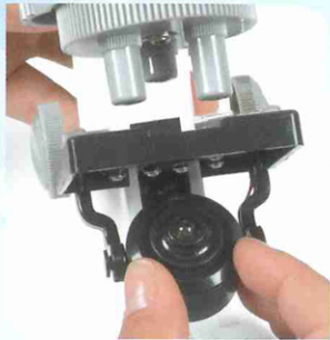
A Die Kuppel nach links drehen und herausnehmen.
