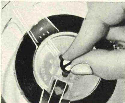
**4. MISE EN PLACE DE LA BOBINE DEBITRICE.** Enfiler la bobine dans le pivot avant. Ce pivot est fendu et élastique pour retenir la bobine.
