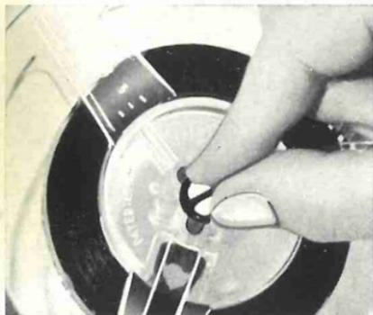
**4. INTRODUCTION DE LA BOBINE DEBITRICE.** Enfiler la bobine dans le pivot du bras avant. Ce pivot est muni d'un dispositif élastique qui retient la bobine.
