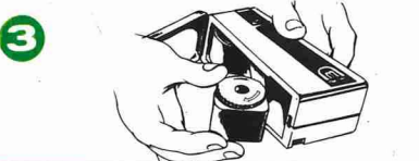
Fig. 3 - Inserire il caricatore nell'apparecchio, mantenendo il rocchetto R in alto. Il caricatore si deve inserire comodamente nell'apposita sede. Quindi chiudere.
