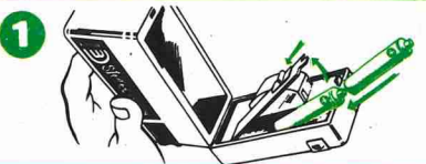
Fig. 1 - Per il tipo 102 «light» spostare la levetta su OPEN per aprire lo sportello e inserire le 2 pile rotonde da Volt 1.50.
